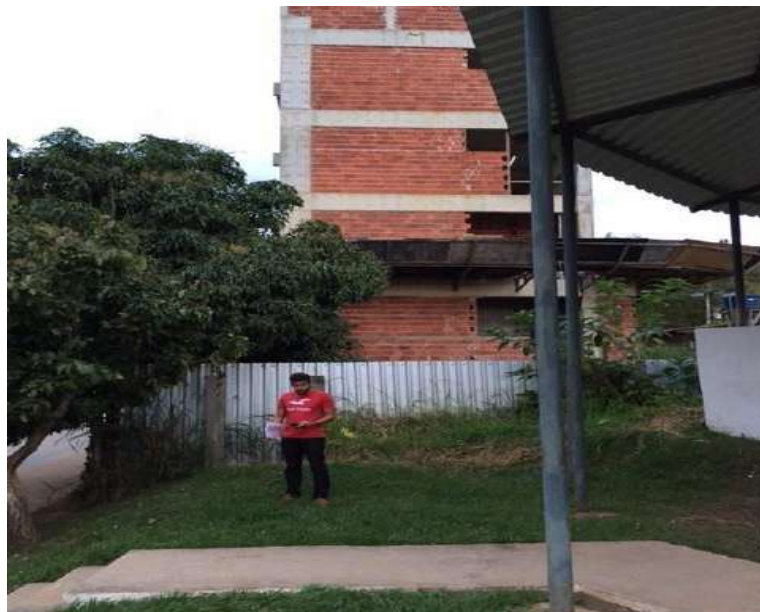
Figura 25 – Obtenção da altimetria do ponto do SPT 27 com aparelho GPS.
